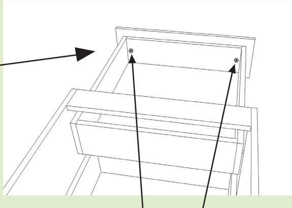
Le système de coulisse standard a aucun ajustement réglable. On peut se servir de ces 2 vis à l'intérieur de la boîte de tiroir pour placer au niveau la façade de tiroir au besoin.
